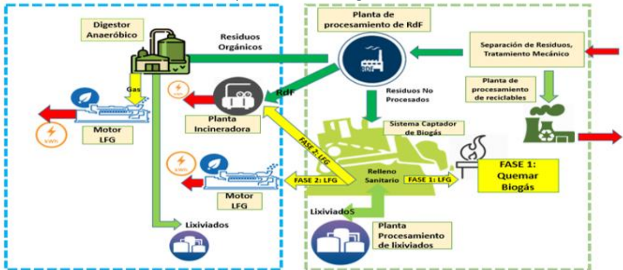
Gráfica 9. Esquema de Inversiones y/o tecnologías de conversión de biomasa en electricidad a través de la incineración de RSU con aprovechamiento de gas de vertedero.
